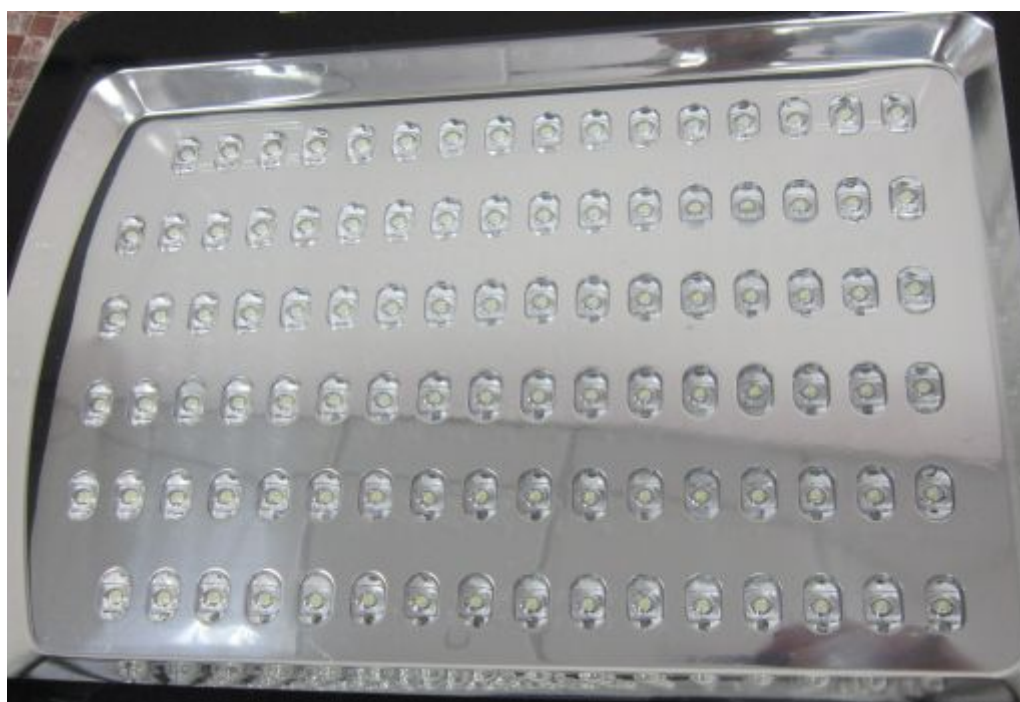
Рисунок 1. Выходное окно светильника после всех типов воздействий по ГОСТ IEC 60598-1-2013. Проникновение влаги и пыли внутрь оболочки отсутствует.
